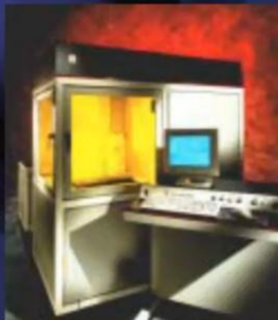
Прецизионная стереолитография - стереолитографическая установка SLA-Viper si2tm (3D System, США)
