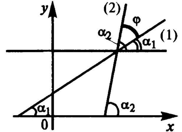
где стрелка означает, что угол  $\varphi$  получается поворотом прямой (1) к прямой (2) против часовой стрелки.
