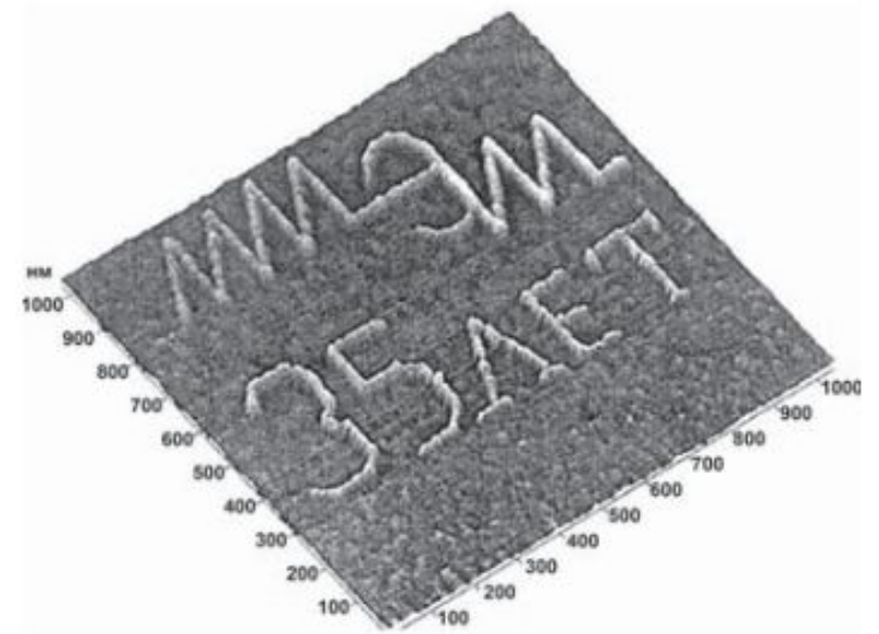
Рис. 4.84. Топография дорожек диоксида титана на титановой подложке, полученных окислением с помощью СЗМ (МИЭТ, 2000 г.)
