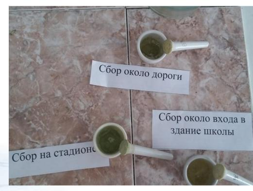
Прокипятили на электропечи, чтобы свинец перешел в раствор, охладили его и отфильтровали.
