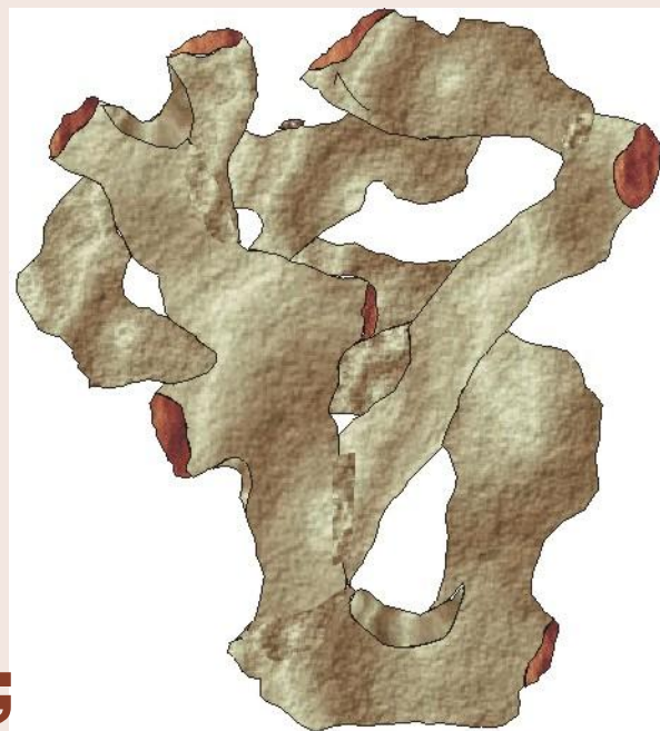
Рис.5. Слепок поровых каналов сцементированного песчаника
