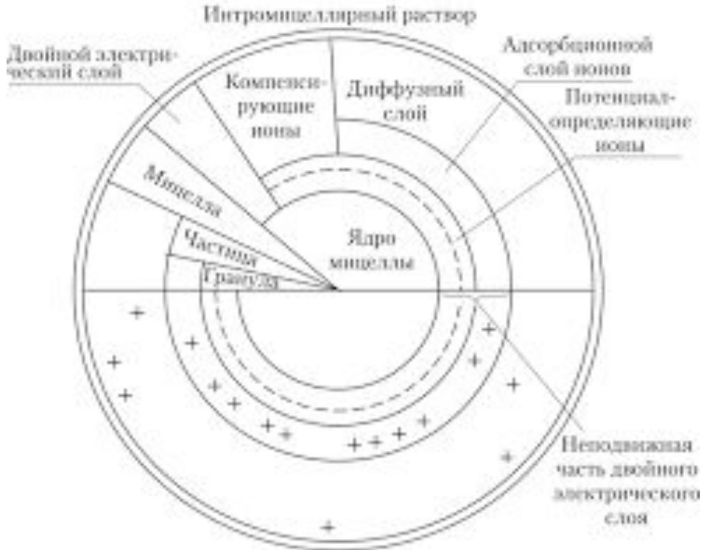
Коллоидная мицелла состоит из ядра, слоя потенциал-определяющих ионов, неподвижного и диффузионного слоя компенсирующих ионов.
