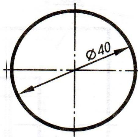
Если диаметр больше 40 мм, то размерные числа и стрелки располагают внутри окружности.
