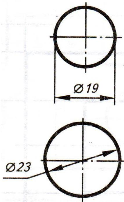
Если диаметр больше 20 мм и меньше 40 мм, то стрелки располагают внутри элемента, размерные числа — снаружи.
