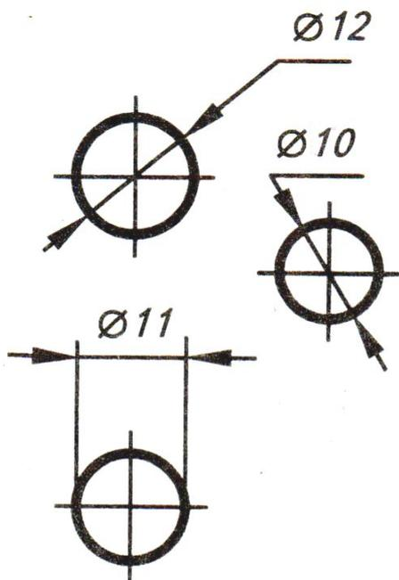
Если диаметр меньше 12 мм, то размерные числа и стрелки располагают снаружи окружности.
