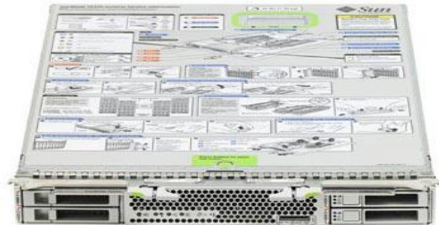
Типичный Blade-сервер (Sun Blade X6250)
