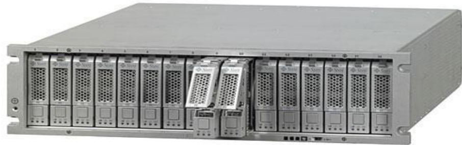
Типичная Система хранения данных начального уровня (Sun StorageTek 6140)
