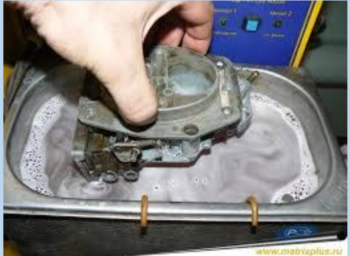
При таком способе очистки деталей и агрегатов потребуется достаточно большое количество солянки или бензина. Для начала деталь смачивают, чтобы разбить загрязнение, потом механическим способом тряпкой или щеткой растирают грязь и в дальнейшем ополаскивают или стирают грязь сухой тряпкой.
