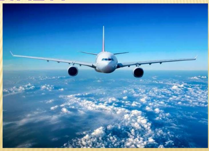
Самолет держится в воздухе за счет подъемной силы. Она, в свою очередь, возникает, когда потоки воздуха движутся навстречу крылу. Крыло повернуто под точным углом и при определенной скорости самолета начинает "взлетать", стремиться вверх. Встречный поток воздуха постоянно поддерживает крыло, не давая ему упасть.
