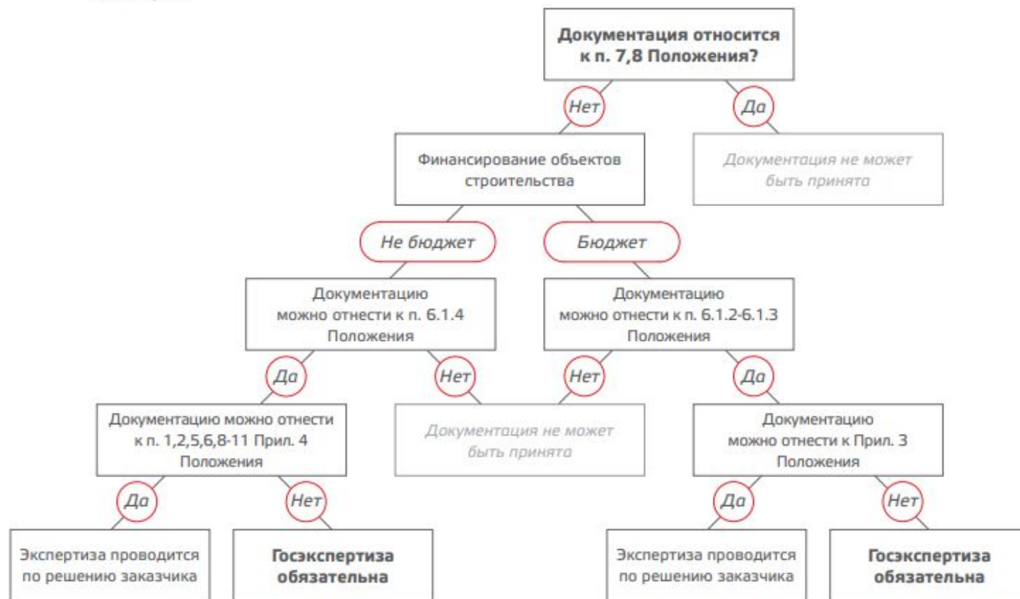
Рис. Логическая блок-схема для принятия решения о необходимости проведения первичной государственной экспертизы
