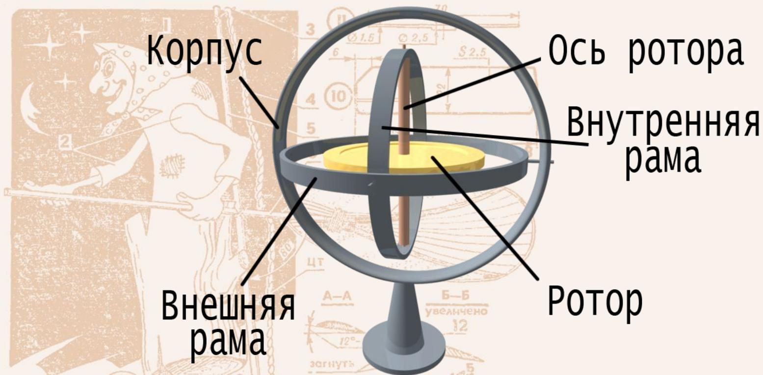
**Гироскоп – это устройство, способное реагировать на изменение углов ориентации тела, на котором оно установлено, относительно инерциальной системы отсчёта.**
