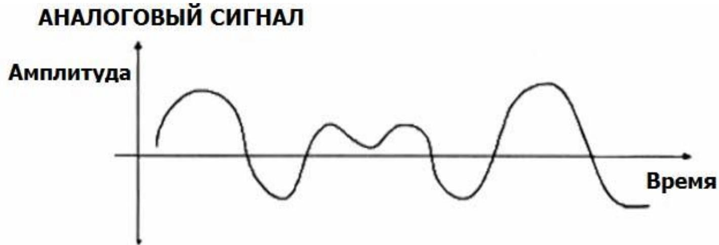
**Аналоговый сигнал** (analog signal) является непрерывной или кусочно-непрерывной функцией  $y=x(t)$  непрерывного аргумента, т.е. как сама функция, так и ее аргумент могут принимать любые значения в пределах некоторого интервала  $y_1 \leq y \leq y_2, t_1 \leq t \leq t_2$ .
