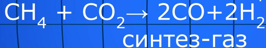
Реакции протекают при  $800-900^{\circ}\text{C}$  и в присутствии катализатора ( $\text{Ni}$ ,  $\text{MgO}$ ,  $\text{Al}_2\text{O}_3$ )
