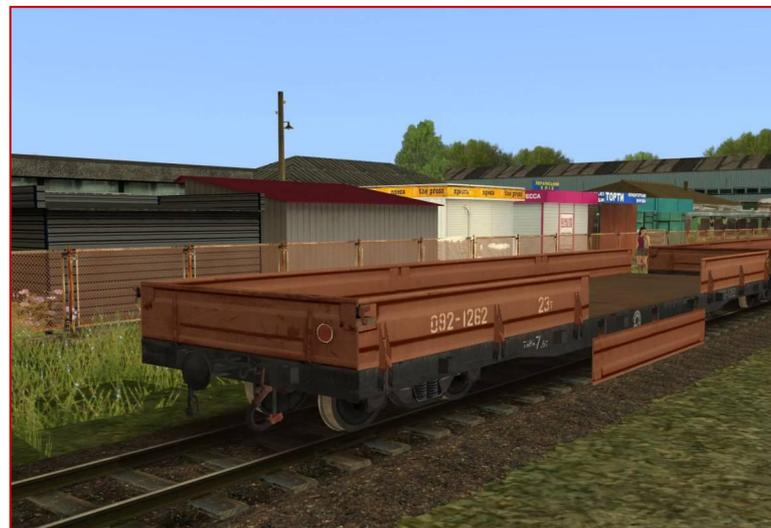
После выгрузки грузов вагоны, контейнеры должны быть очищены внутри и снаружи, с них должны быть сняты приспособления для крепления груза, за исключением несъемных приспособлений для крепления
