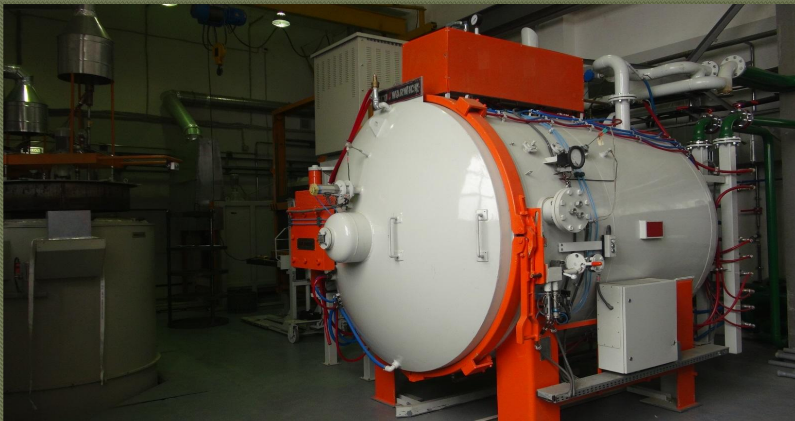
Вакуумная печь (Seco/Warwick) 10 VPT 4050/48 в цехе ООО «СЦТ»
