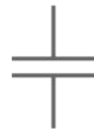
Обозначение конденсатора на схеме
