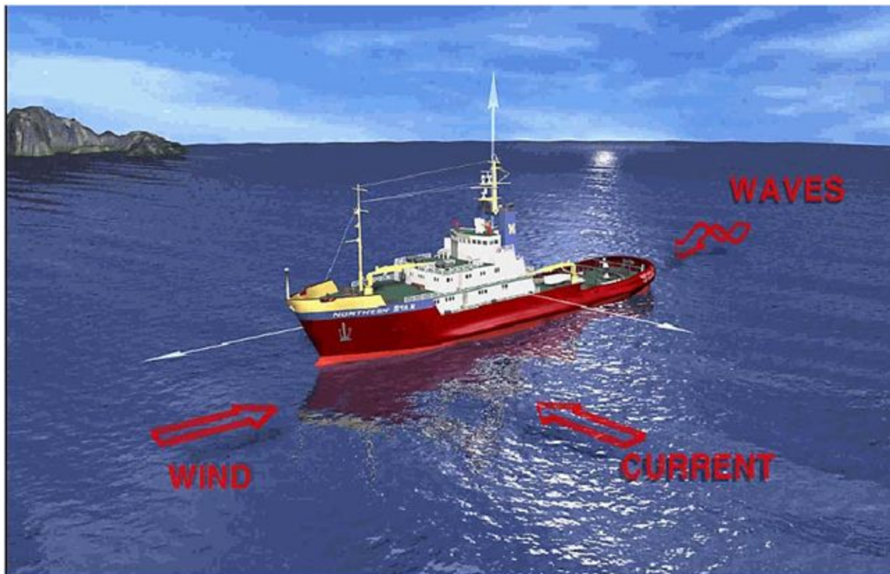
Рис. 1.20. Воздействие внешних сил на корпус судна
