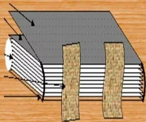
Книжный блок состоит из бумажных листов, собранных в тетради, в определённом порядке и скреплённых между собой. Место скрепления тетрадей в готовой книге называется корешок
