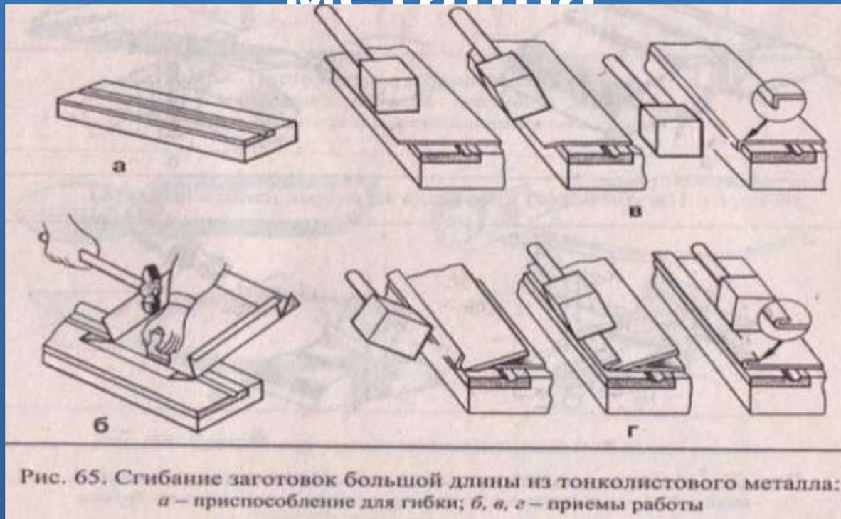
При гибки заготовок большой длины (например, при производстве кровельных работ) используется металлическая полоса или деревянный брусок.
