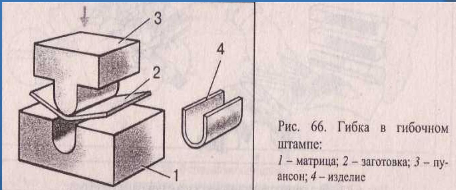
Гибка в гибочном штампе применяется на предприятиях при массовом производстве изделий и выполняется кузнецами или штамповщиками
