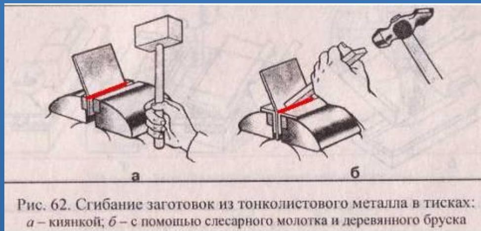
При закреплении заготовки линия сгиба ( \_\_\_\_\_ ) должна быть расположена на уровне нагубников
