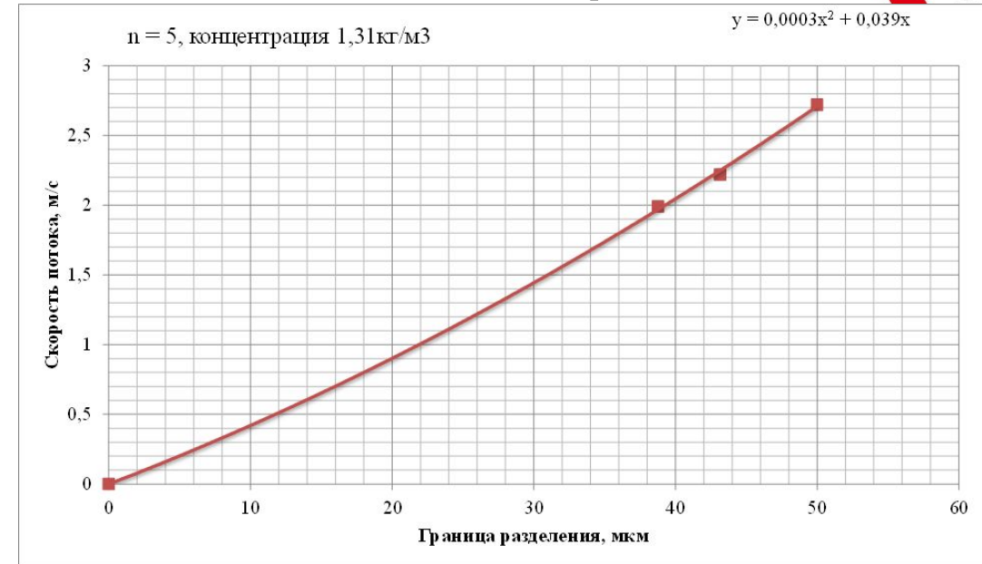
ГРАФИК ЗАВИСИМОСТИ ГРАНИЦЫ РАЗДЕЛЕНИЯ ОТ СКОРОСТИ ВОЗДУШНОГО ПОТОКА ПРИ КОНЦЕНТРАЦИИ 1,31 КГ/М 3
