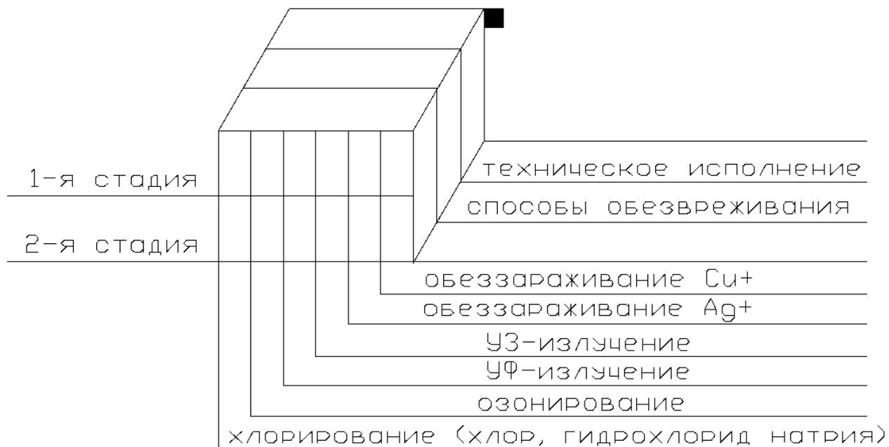
Рис.6.2. Морфологическая матрица структурных возможностей выбора способа обеззараживания и его технического исполнения
