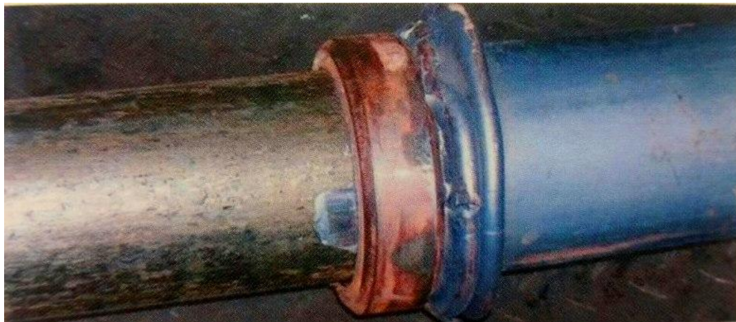
Труба, приварившаяся к оправке
