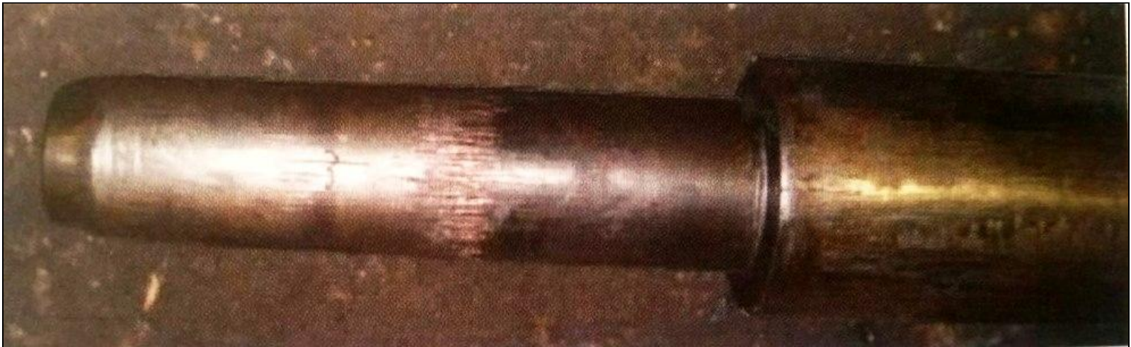
Износ пуансона вследствие недостаточной смазки
