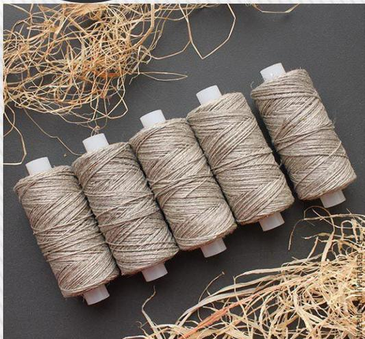
**Нитки льняные** характеризуется высокой прочностью, малой растяжимостью, низкой электризуемостью, устойчивостью к солнечному и тепловому излучению
