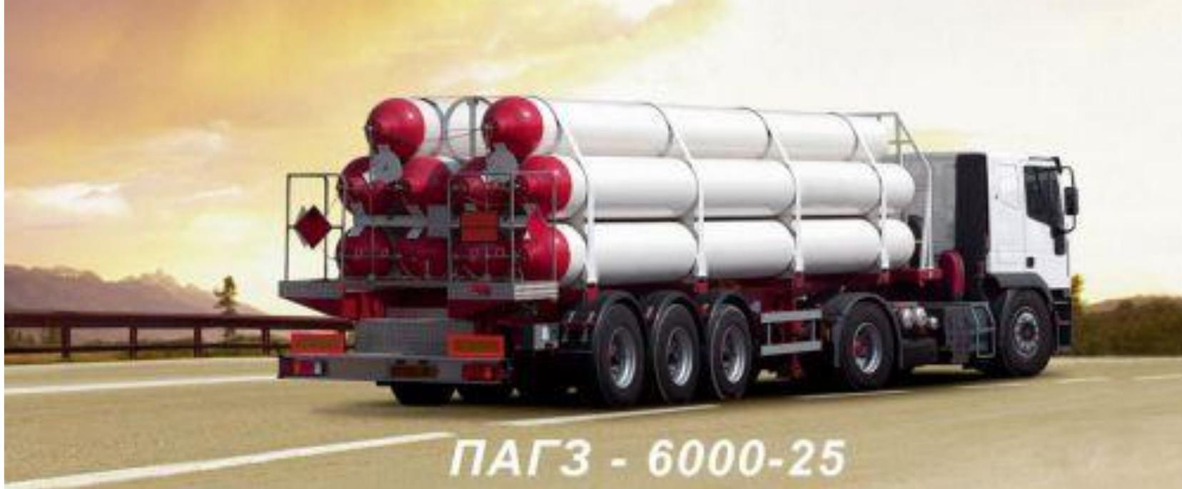
Передвижной автогазозаправщик ПАГЗ предназначен для транспортировки и хранения сжатого природного газа, заправки техники, стационарных аккумуляторных газовых станций, использующих природный газ как моторное топливо, для хранения газа и снабжения газом бытовых потребителей.
