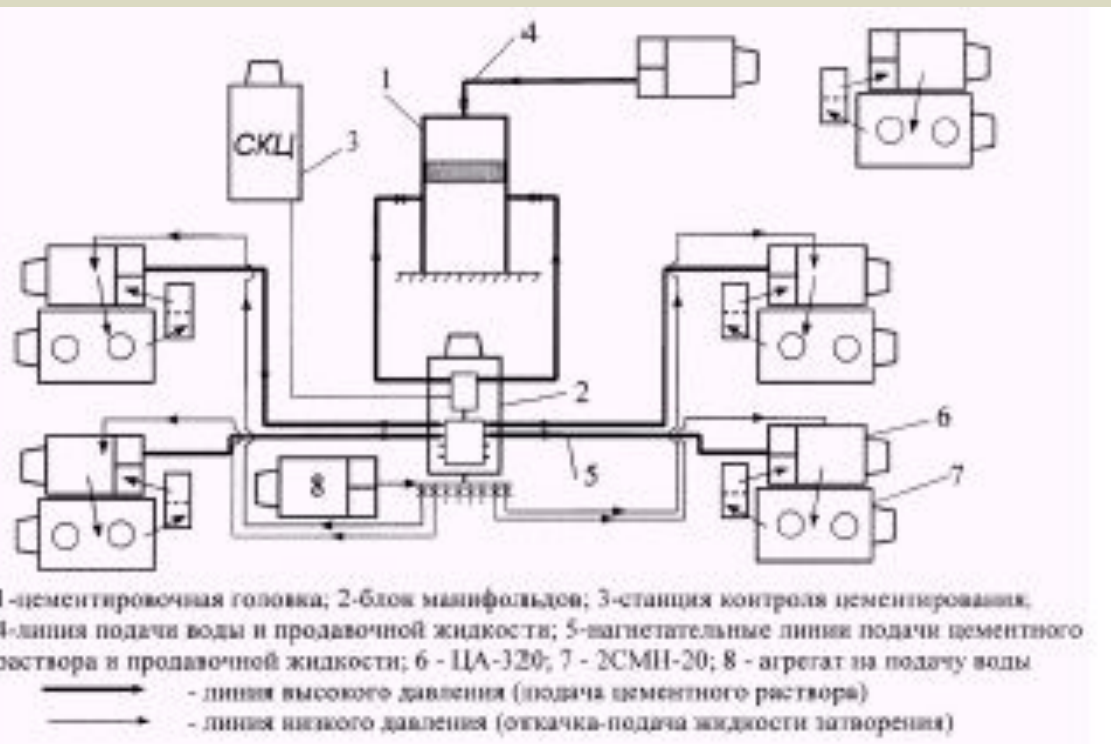
Рис. 1. Технологическая схема обвязки цементирующей техники при цементировании эксплуатационной колонны с получением цементного раствора в гидروвакуумных цементосмесителях
