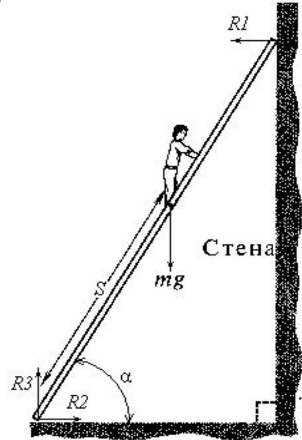
*Решение.* Предположим, что человек находится на критической высоте –  $S$ , при которой сила трения достигла максимально возможной величины. Освободим лестницу, заменив связи ее с полом и стеной реакциями  $R_1$ ,  $R_2$ ,  $R_3$ . Реакция  $R_2$  - это сила трения, модуль которой выражается через коэффициент трения -  $\mu$  формулой сухого трения  $R_2=R_3*\mu$ .
