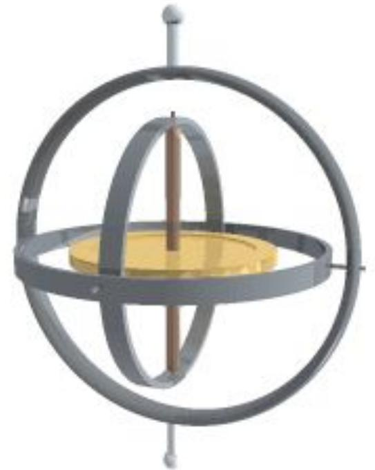
Это обеспечивается законом сохранения момента импульса, поскольку внешний вращающий момент, действующий на ротор, очень мал. Даже если движение подвеса за счет трения в нем создаст вращающий момент, поворачивающий ось ротора, согласно (5.7), скорость и величина прецессии будут очень малыми за счет большой величины момента импульса ротора.
