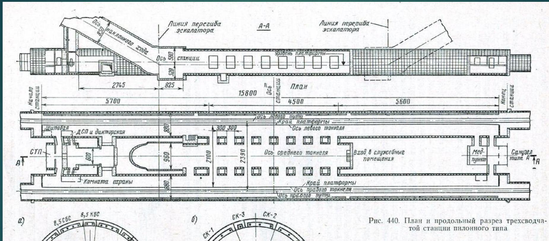
Рис. 440. План и продольный разрез трехсводчатой станции пилонного типа
